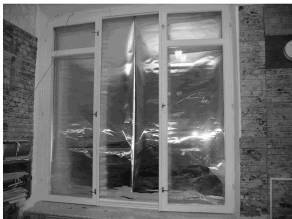
Рис. 4. Экспериментальный оконный блок АлтГТУ с управляемыми теплотехническими характеристиками по технологии УЭВС с закрытым экраном (внутренний вид)
